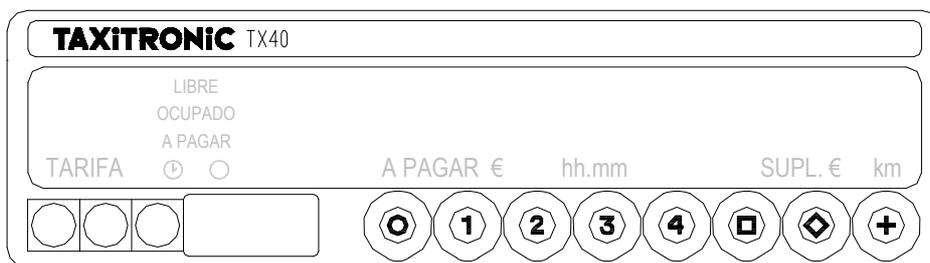
Pulsar la tecla **0** para pasar a ON. Si hay un código de acceso programado, el segundo punto decimal del display de estado se encenderá intermitentemente indicando que se espera la introducción del código correcto.
