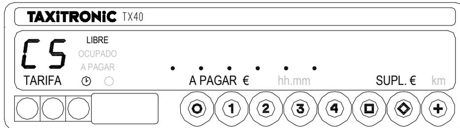
Pulsar la tecla **□**. El punto decimal del dígito de la derecha del display de importe se pondrá intermitente, indicando que se ha solicitado la visualización de bloque de control.
